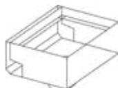
Revisionsschacht mit Anschluss unten
