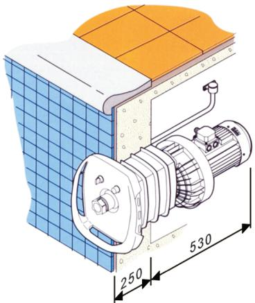
04745 **Armatur eckig ABS**, komplett mit Düsenstock mit PN-Taster, und integriertem Haltegriff. (11013)
