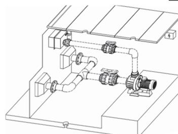
4660431 **Ansaugung einzeln**, komplett mit Flanschsatz (66043R0510)
