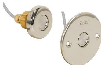
02821 **Piezoschalteinsatz mit Kontermutter 1"** (8716220) und Dichtung für Fertigbecken, ohne Steuerung, Blende V4A, D=49mm Bohrung 32mm, inkl. 10m Kabel
