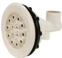
29322 **Jet-Düse KS**, komplett mit Dichtung und Kontermutter mit integriertem Luftinjektor, Wasseranschluss DA60, Luftanschluss DA20, Düsenöffnung 47 mm, erforderliche Wassermenge: min. 40 m<sup>3</sup>/h bei 10 m WS, erforderliche Bohrung für den Einbau: 120 mm
