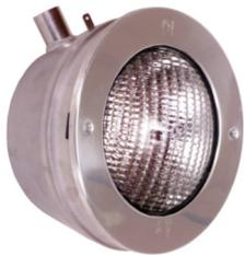
04285 **Edelstahlscheinwerfer V4A 300 W, 12 V, komplett** mit Einbaunische, Blende D 250 mm für Fliesen-, Folien- oder Fertigbecken, mit **Kabelschutzschlauch**. (ohne Flanschsatz) (00358)
