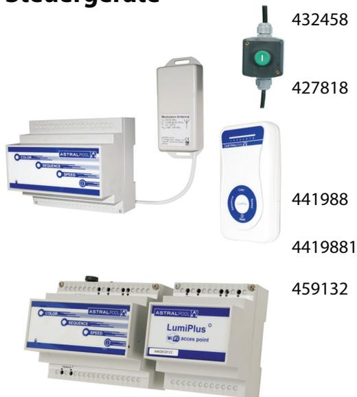
**432458 Externer Farbwahlschalter**, ermöglicht die Kontrolle von bis zu 900 VA, 7 Farb- und 7 Sequenzeinstellungen, der Taster wird am Trafo primärseitig 230 V zwischengeschaltet.
