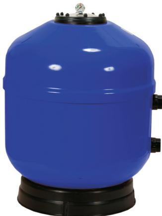
441615FL **Polyesterfilter Typ EUROPA D 750 mit Manometer, (ohne Ventil), Flansch Deckel transparent Farbe blau**, Anschluss 2 ", H 1.085 mm, ohne Filtermaterial
