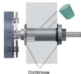
Abbildung 5: Ausgiessen der Mauerdurchführung
