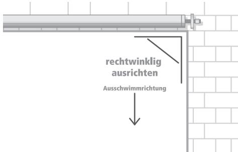
Aufrollvorrichtung am Beckenrand parallel zur Ausschwimmrichtung der Thermocover positionieren. Die Wickelwelle muss auf der Beckenseite bündig mit dem Beckenrand sein und im rechten Winkel zur Beckenseitenwand stehen.
