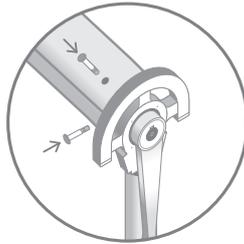
Aufrollvorrichtung zusammenstecken und die Wickelwelle mit je drei Schrauben mit den Nocken verbinden.
