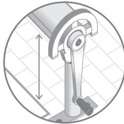
Aufrollvorrichtung am Beckenrand parallel zur Ausschwimmerichtung der Thermocover positionieren. Die Wickelwelle muss auf der Beckenseite bündig mit dem Beckenrand sein und im rechten Winkel zur Beckenseitenwand stehen.
