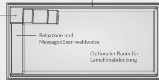
Integrierte Kante für eine sichere Auflage der Lamellenabdeckung
