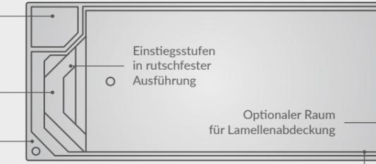
Integrierter Technischacht (optional) mit Abdeckung in Poolfarbe zur Aufnahme der Filteranlage
