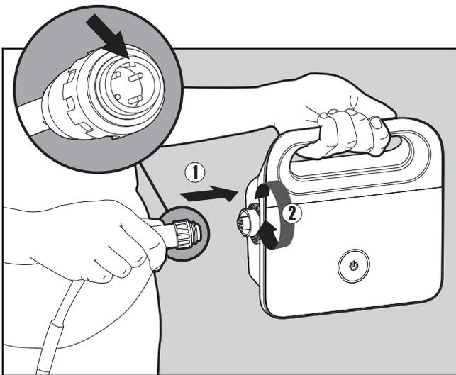
**5.1.3** Das Schwimmkabel mit dem Stromversorgungsgerät verbinden, indem Sie es so einföhren, dass die Nut am Stecker (1) auf die Kerbe im Anschluss am Stromversorgungsgerät ausgerichtet ist, und es im Uhrzeigersinn drehen (2).
