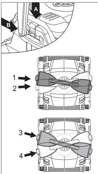
Ändern Sie die Position der Griffs für die Seitwärtsbewegung des Roboters entlang der Wasserlinie.
